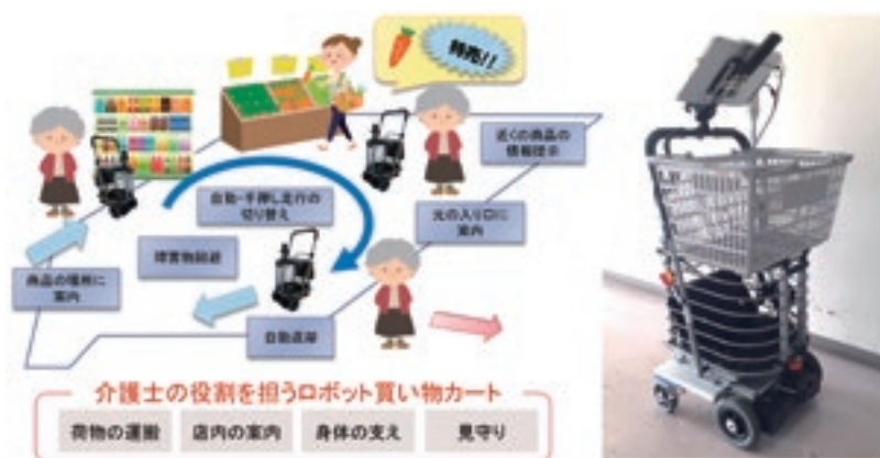
(図1・左)ロボット買い物カート。高齢者の買い物リハビリを支援する機能を備えている。 (写真5・右)状況に応じた位置関係の調整。ロボット買い物カートが商品を手に取ったユーザの隣にきている。
