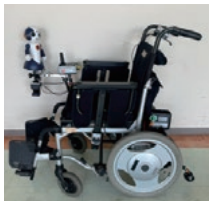
(写真6・左) 車いすに搭載したコミュニケーションロボット。進路や目的地を示したり、雑談に応じたりする。
