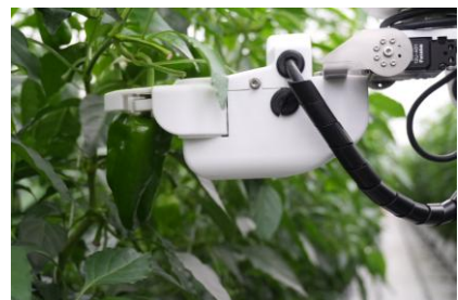
ピーマンの自動収穫ロボット 画像提供：AGRIST ( https://agrist.com/ )
